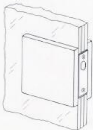
ART. 323 C/CARTELLA 180° - SERRATURA CENTRALE VETRI TEMPERATI STRATIFICATI 15 - 19 OTTONE - ALLUMINIO - INOX
