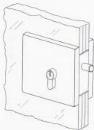
ART. 322 SERRATURA CENTRALE VETRI TEMPERATI STRATIFICATI 15 - 19 OTTONE - ALLUMINIO - INOX
