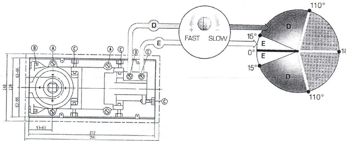
Area di controllo idraulico valvola E
